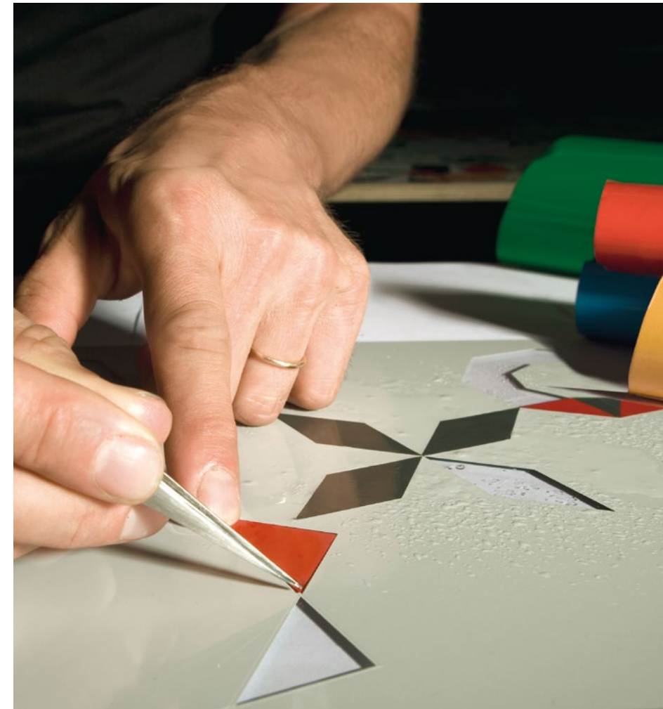
3 Adhesive film inlaid on glass by hand / Intarsio artigianale su vetro della pellicola adesiva
